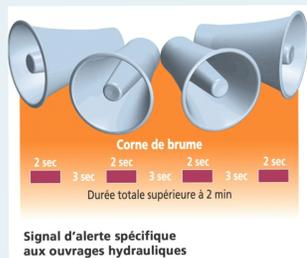
**Signal d'alerte** : l'alerte a une durée de 2 minutes, soit 24 impulsions de 2 secondes, avec 23 intervalles de silence de 3 secondes.
